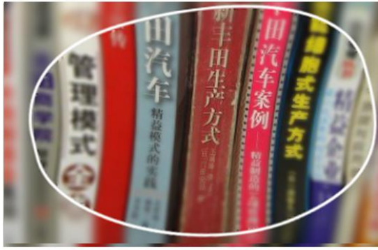
球面镜片中距离视野 越到镜片边缘清晰度越下降 同时影像歪曲变形较多
