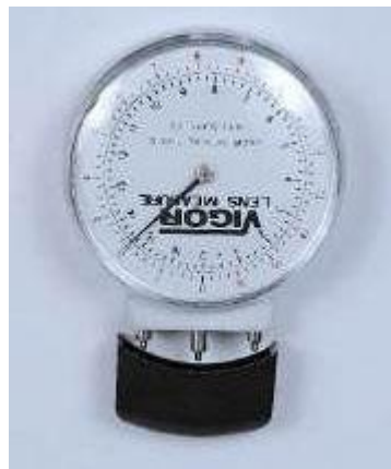
插图 7 测量镜片表面矢高用的矢高表
